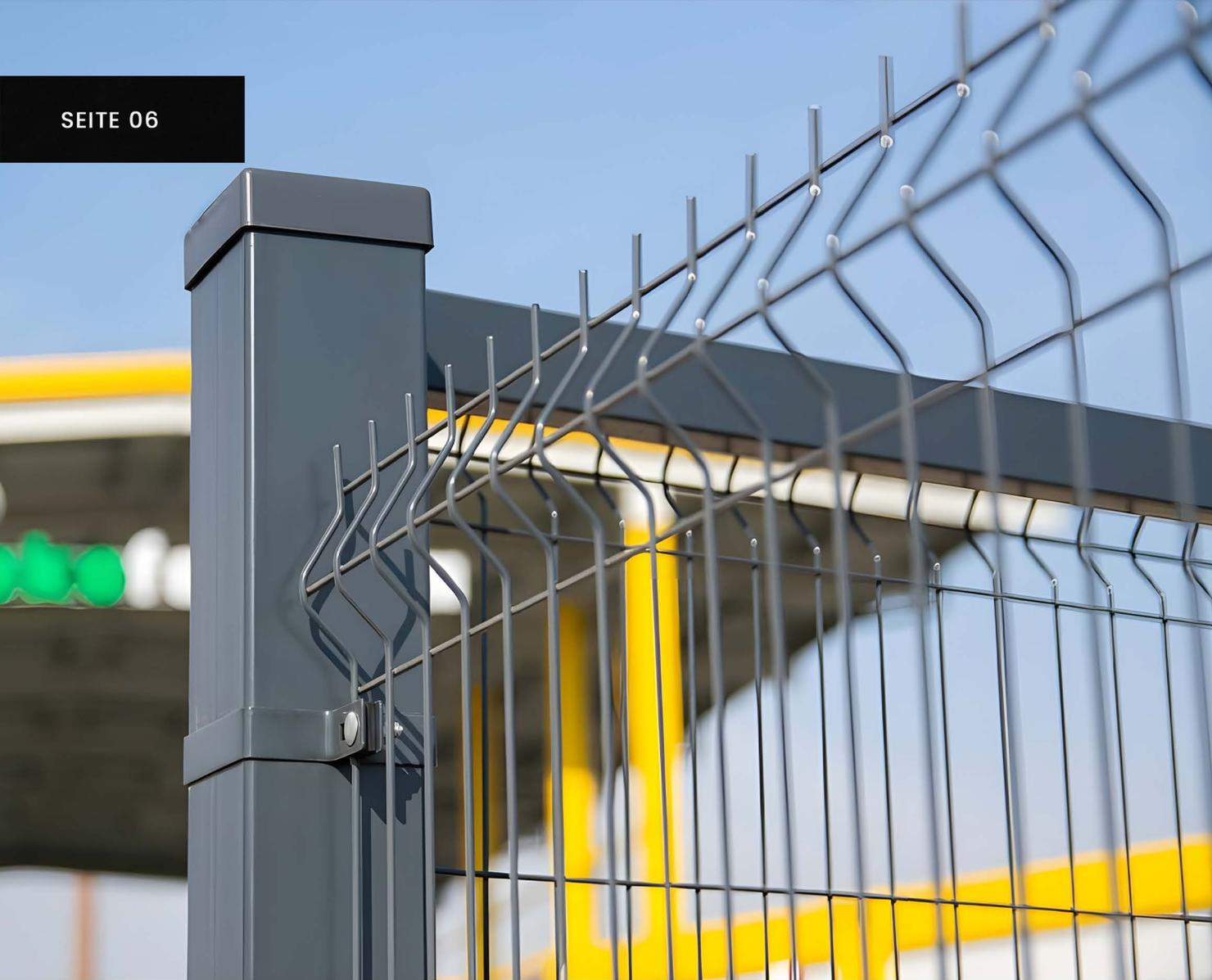
Das 3D-Paneelsystem zeichnet sich durch rechteckige Maschen mit den Maßen 50×200 mm oder 55×200 mm aus. Ein typisches Merkmal sind die 3D-Prägungen, die dem System zusätzliche Steifigkeit verleihen. Zum System gehören Schellen, Pfosten, Abdeckkappen sowie dekorative Zubehörteile wie zum Beispiel Holzleisten als Füllung oder farbige Kunststoffstreifen.
